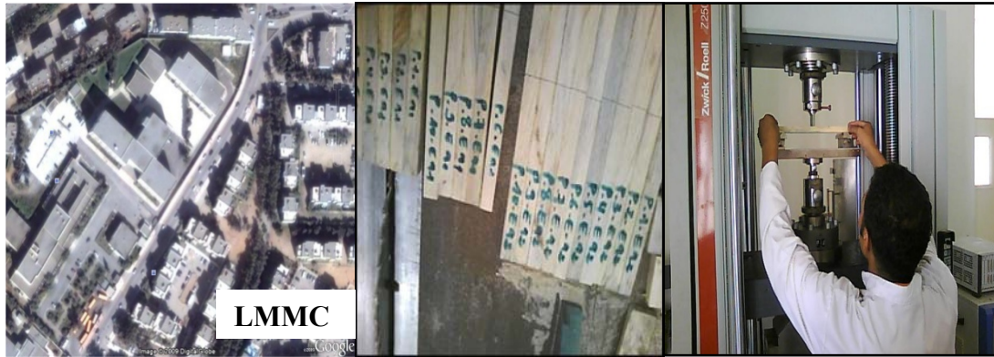
Fig III.22 : Image du labo à partir de l'espace, éprouvettes et réalisation de l'essai flexion trois points.
