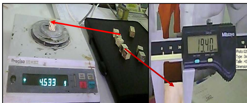
Fig III.7 : Détermination des dimensions et poids des éprouvettes (20*20*20).
