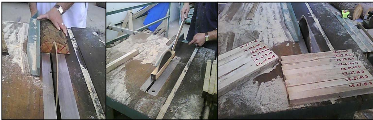
Fig III.5 : Finition des éprouvettes (20*20*340).
