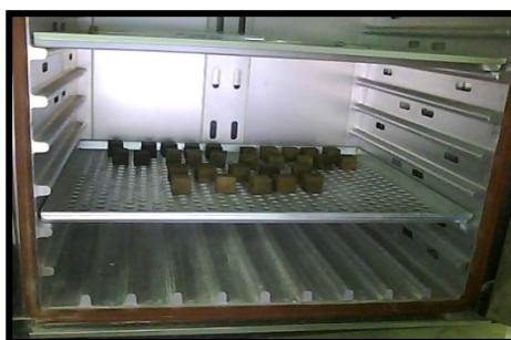
Fig III.15: Éprouvettes de bois ( 20 \times 20 \times 20 ) dans l'étuve de séchage.
