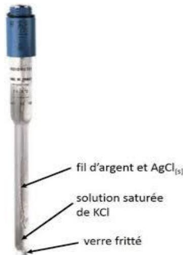
**Figure III.2.** Schéma de principe d'une électrode de chlorure d'argent
