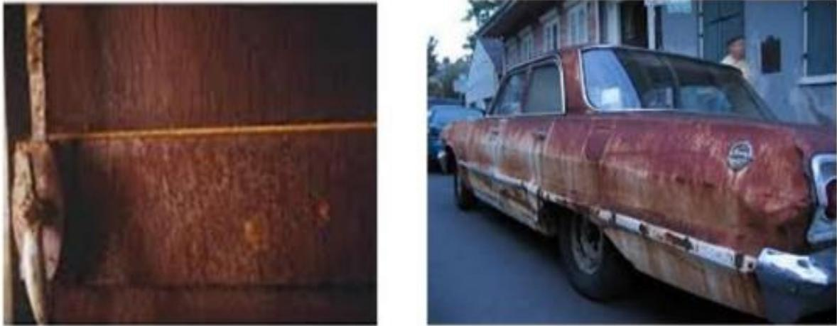
**Figure V. 3 :** Corrosion généralisée : exemple d'une porte et d'un véhicule corrodés.
