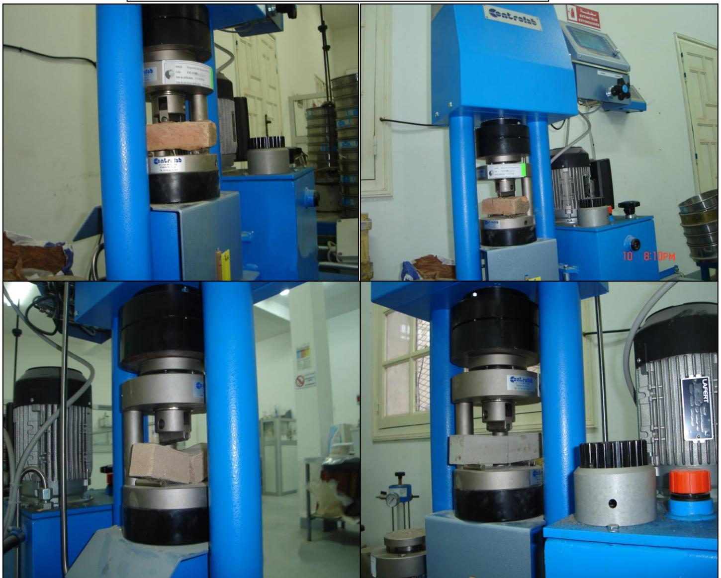
Fig.VI.6 Essai de flexion
