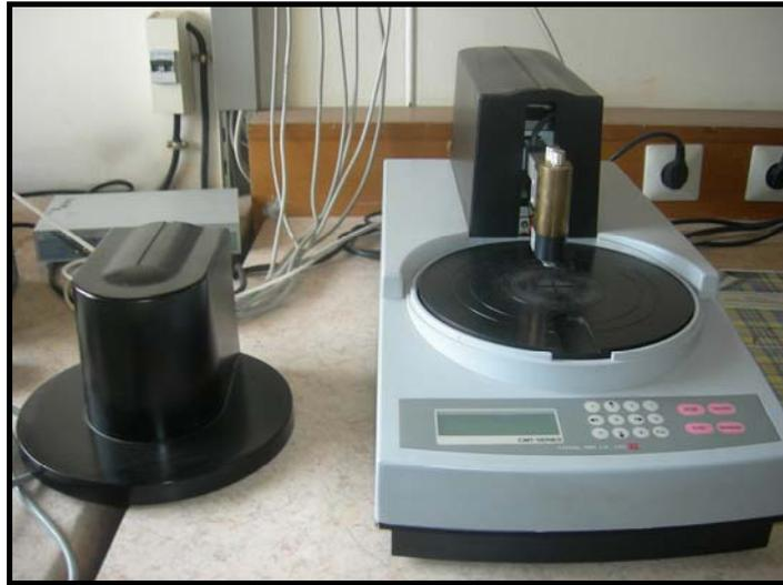
**Figure (III.7) :** Photographie du dispositif de mesure de la résistance carrée
