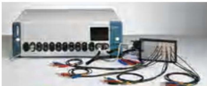
**Figure (III.12) :** *dispositif expérimental utilisé pour le tracé des courbes de polarisation et d'impédance électrochimique (AUTOLAB)*
