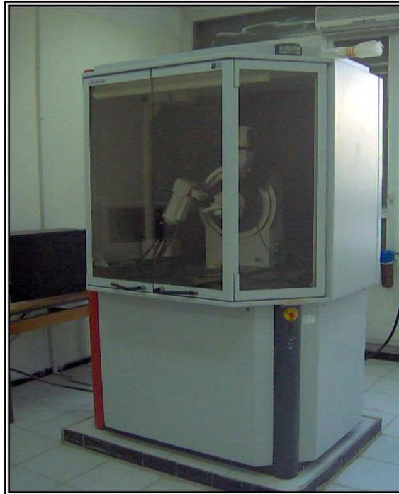
Figure (III.4) : Diffractomètre utilisé (Bruker D8)
