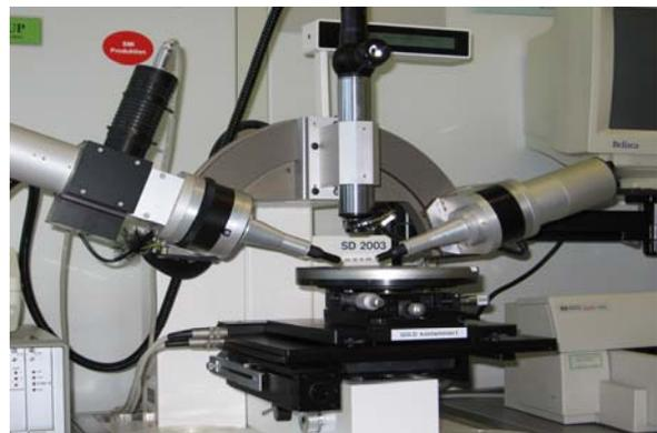
**Figure (III.10) :** *L'ellipsomètre EL X-01*
