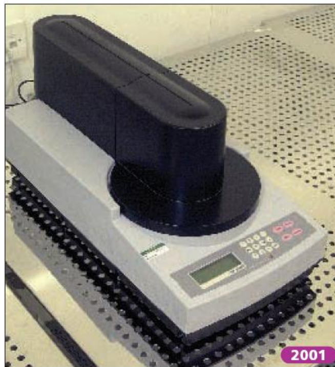
Figure III-13 : Photographie du dispositif de mesure de la résistance carrée
