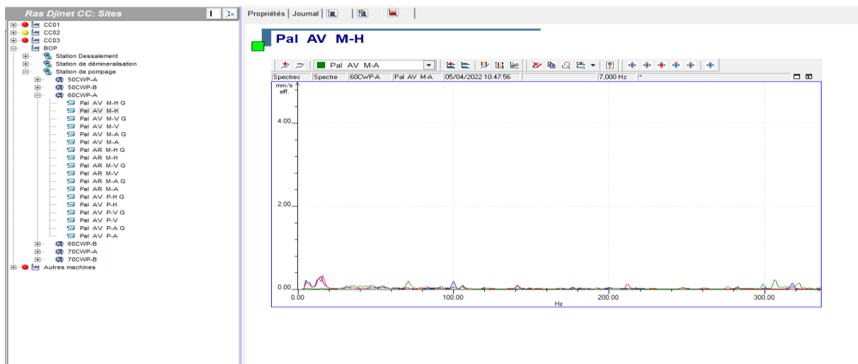
Figure IV .8 Spectre 1 de palier AV-moteur (H-V-A)
