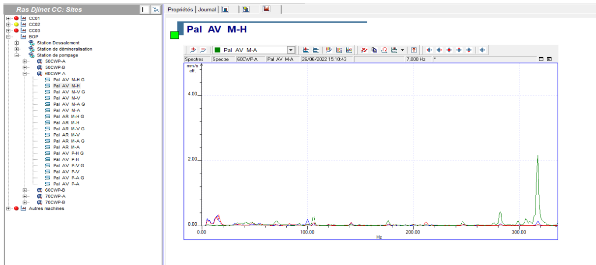
Figure IV.9 Spectre 2 de palier AV-moteur (H-V-A)
