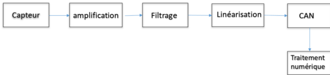
Figure III.26: chaîne d'acquisition d'un capteur de température
