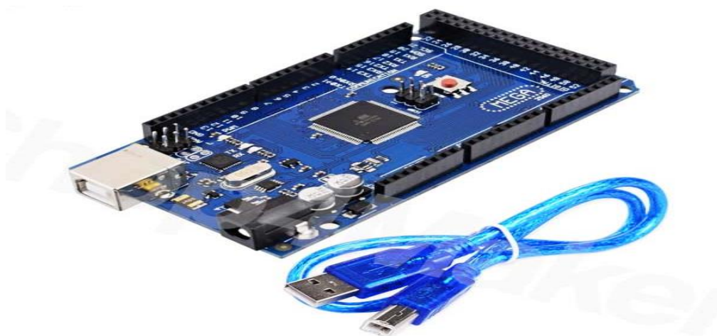
Figure III.38: la carte arduino avec le câble USB [78]
