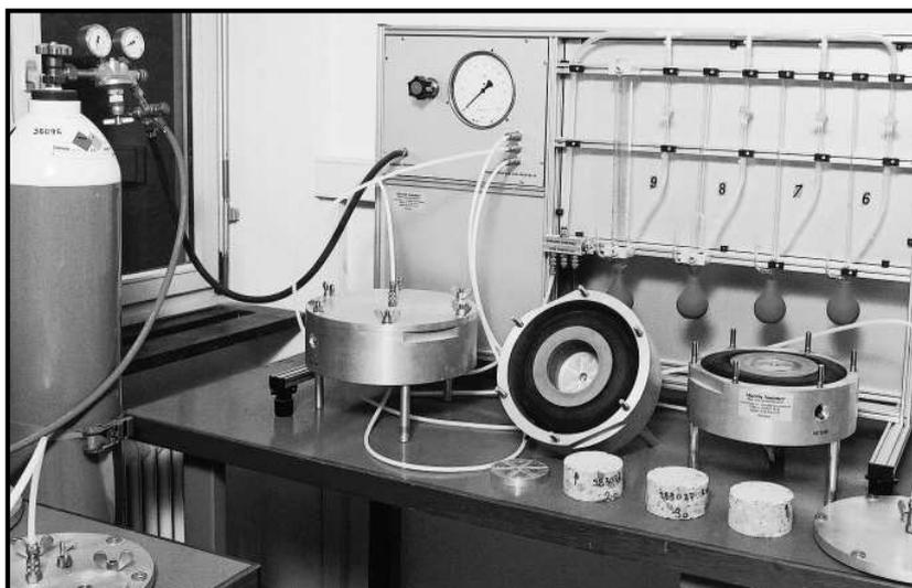
**Figure III.2** : Mesure de la perméabilité au gaz  $k$  selon la méthode CEMBUREAU, [3].
