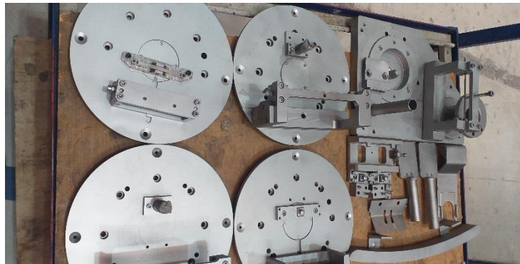
Figure 1.7 : Etat de surface des outils après sablage
