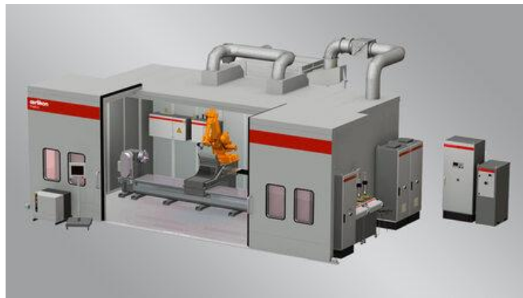
Figure 1.26 : GE Les revêtements de barrière thermique 3D view
