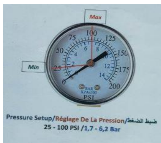
Figure 1.14 : Pressure Setup/Réglage de la Pression 25-100 PSI 1,7-6,2 Bars
