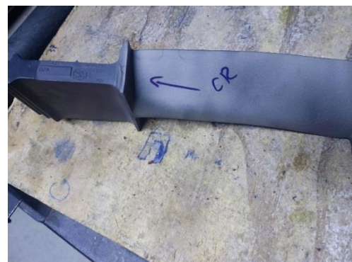
Figure 1.16 : Utilisez une lampe UV pour localiser la fissure
