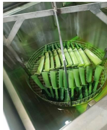
Figure 1.16: Application de produit chimique pénétrant
