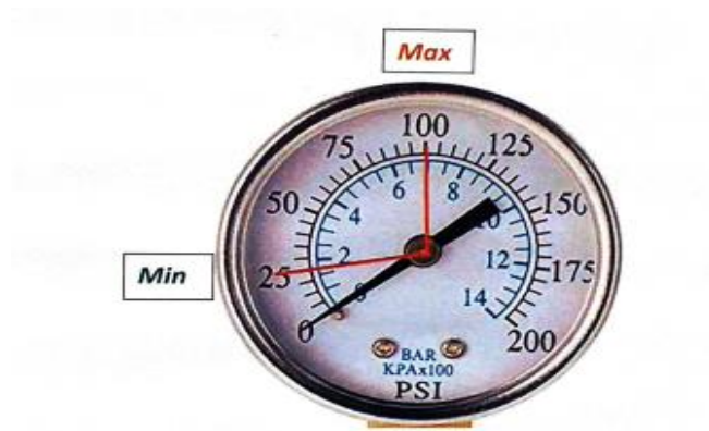
Figure1. 10 : Pressure Setup/Réglage De La Pression / 25-100 PSI / 1,6-6,2 Bar
