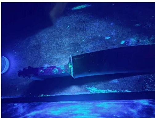
Figure 1.16 : Utilisez une lampe UV pour localiser la fissure
