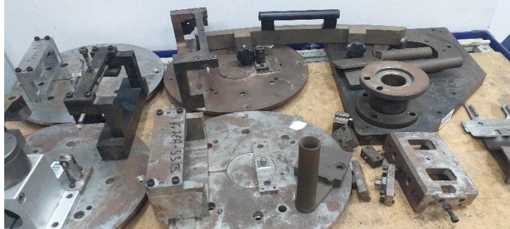
Figure 1.6 : Etat de surface des outils avant sablage
