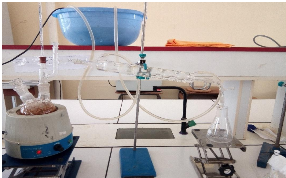
Figure 7 : l'hydrodistillation du clou de girofle.
