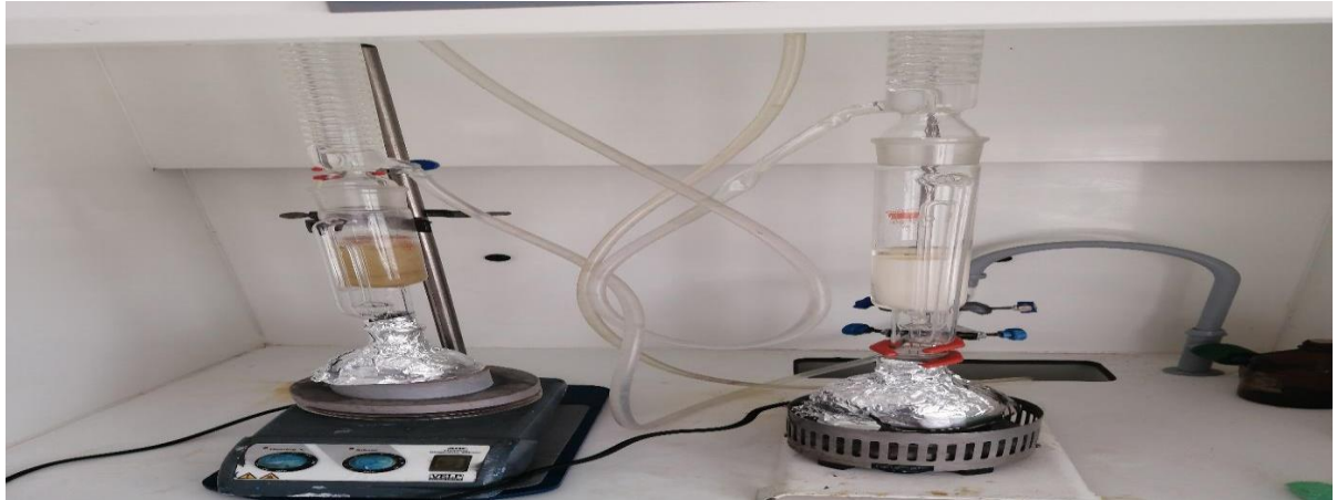
Figure 6 : Montage Soxhlet représentatif d'extraction des matières grasses et des extractibles (Hexane / éthanol)
