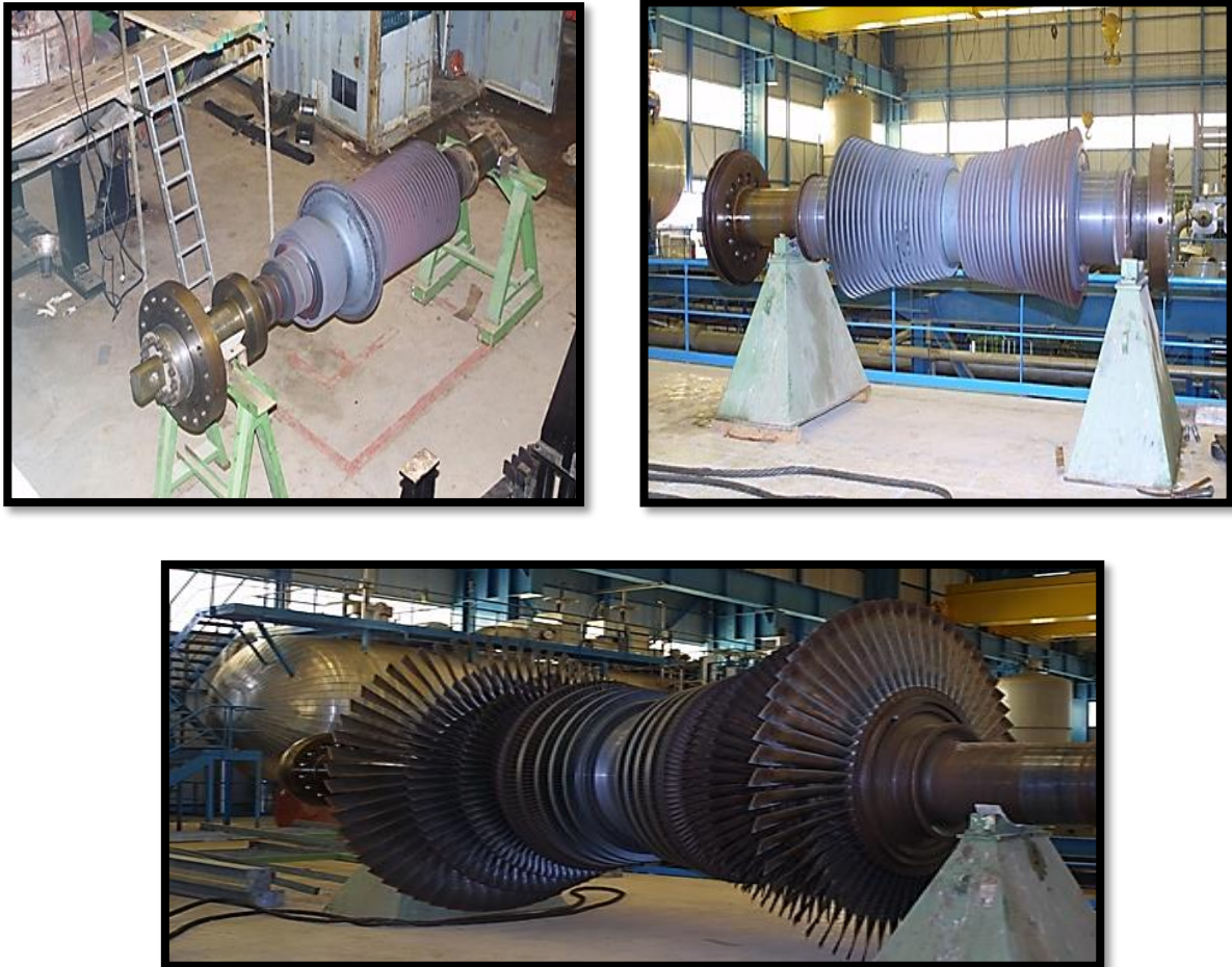
Figure I.3 : images des trois corps de la turbine à vapeur.
