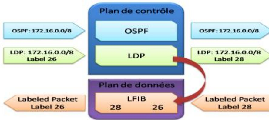
Figure 2. 13 : Plan de contrôle et plan de données.
