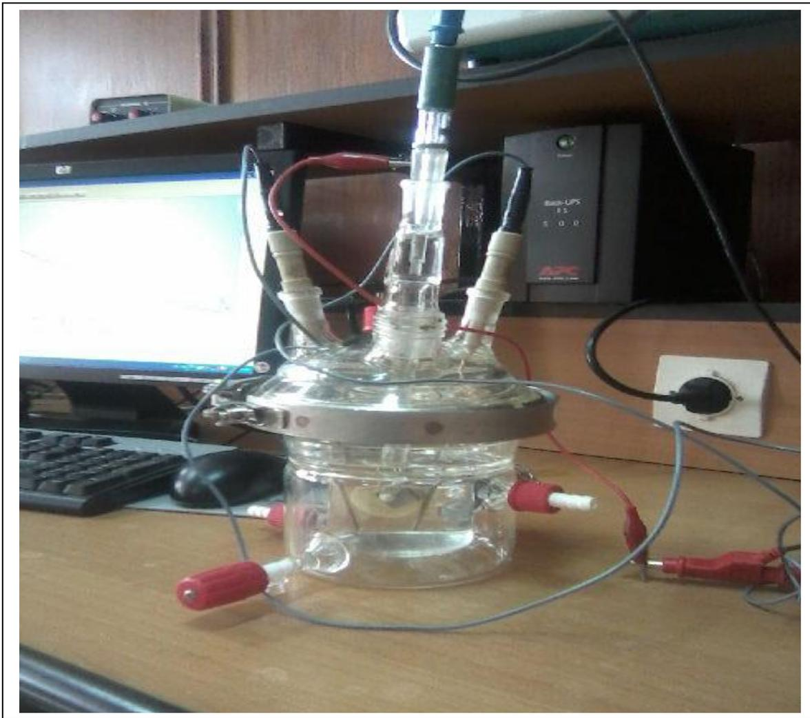
**Figure V.2 :** Photographie représentatif de la cellule électrochimique
