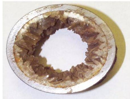
**Figure II.5 :** Formation des dépôts à l'intérieur les conduites
