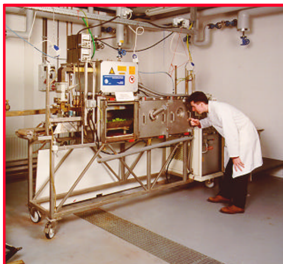
Photo III.2 : Réacteur micro-ondes continu semi industriel pour la synthèse à sec (Puissance 6000 Watts, Longueur 4 mètres, production maximale 100 kg/heure)
