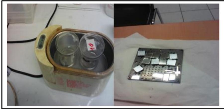
FIGURE 2. 5: a) nettoyage des substrats par ultrasons dans un bain d'acétone et d'alcool, b) Exemple de substrat en acier et silicium.
