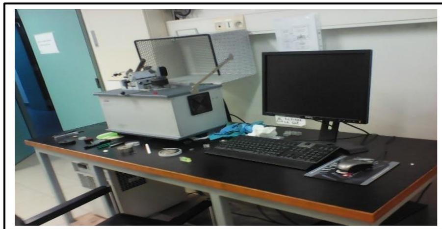
FIGURE 2. 17: Tribomètre rotatif continu (TriboX, CSM Instruments).
