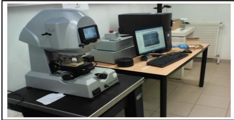
Figure 2. 9: Profilomètre optique VEECO-Wyko NT 1100.
