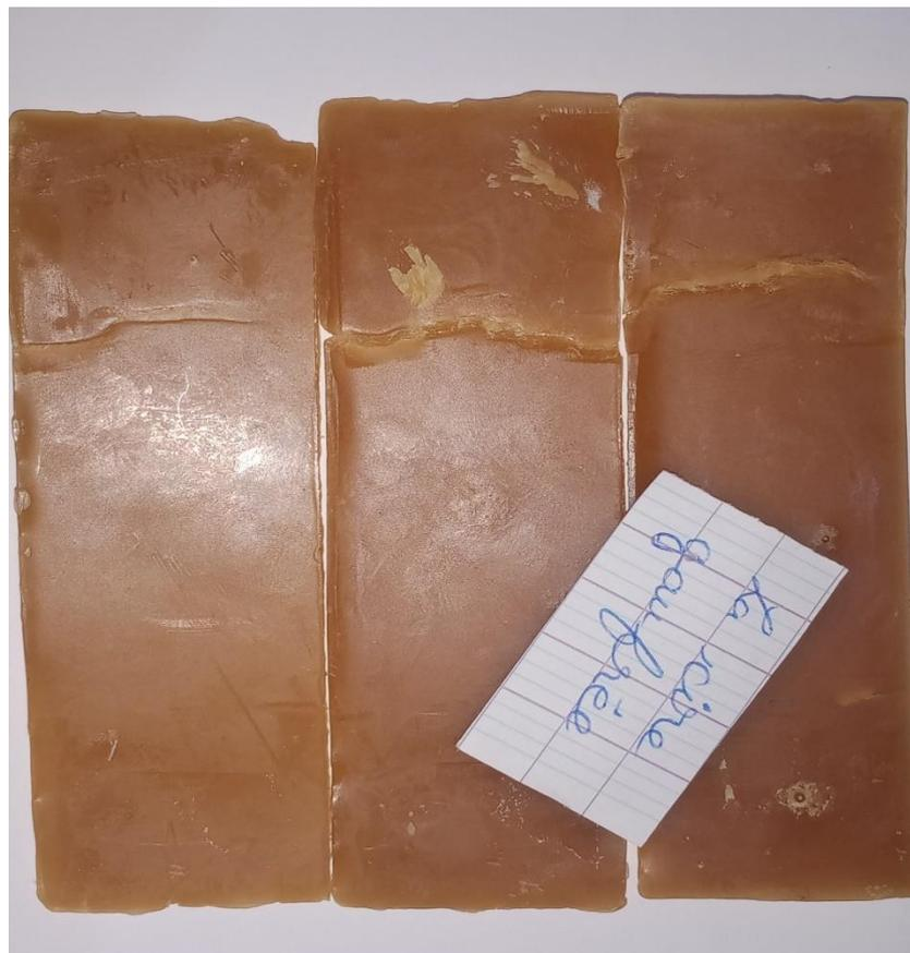
Figure 18: L'effet de traction sur la cire gaufrés.
