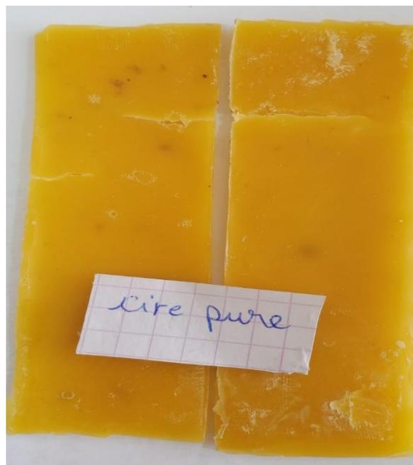
Figure 17: L'effet de teste de traction sur la cire pure.
