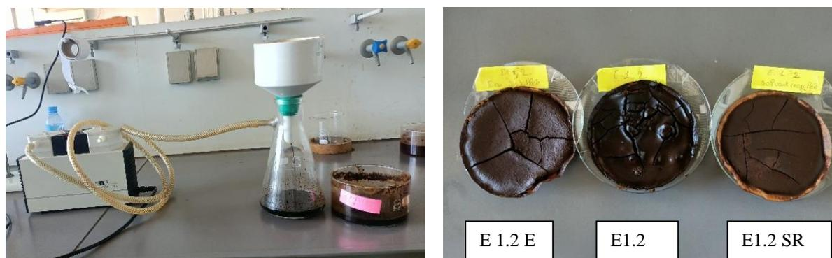
**Figure III.20.** Filtration de la lignine kraft
