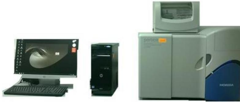
**Figure III.5.** Granulomètre à laser de type LA 950. (CRD-Sonatrach)
