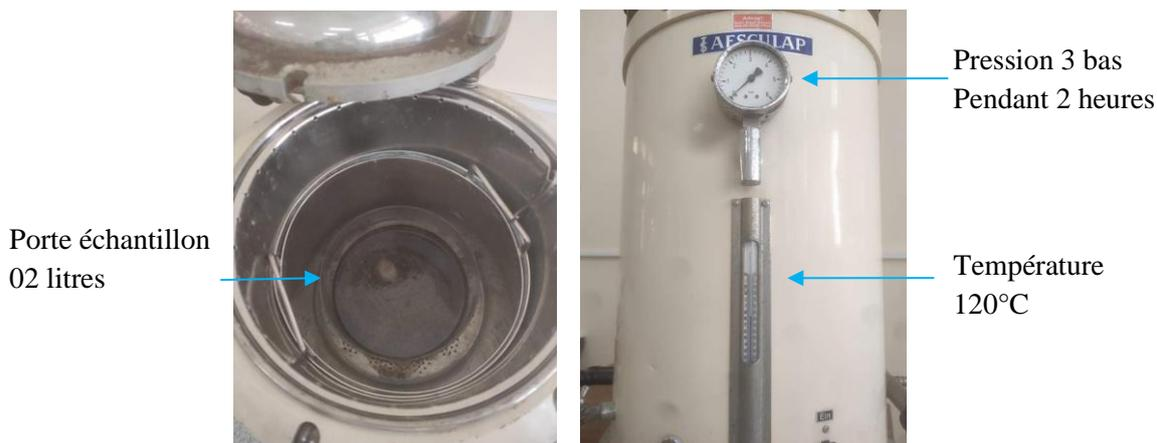
**Figure III.17.** Extraction de la liqueur noire à l'aide d'un autoclave
