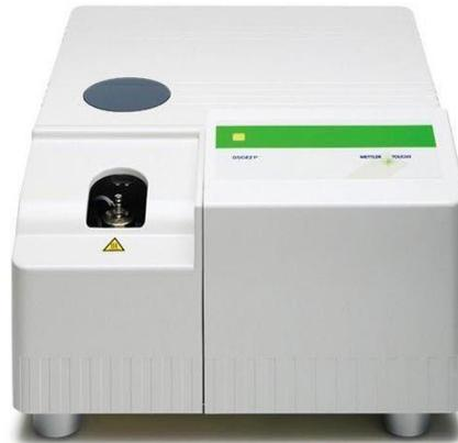
**Figure III.7.** Appareil d'analyse enthalpique différentielle de type Mettler Toledo 823 DSC (LMP-USTHB)
