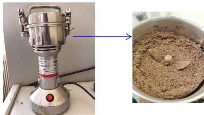
Figure III.12. Broyage automatique d’un moulin électrique
