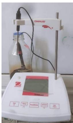
**Figure III.3.** Potentiel d'hydrogène (pH mètre)
