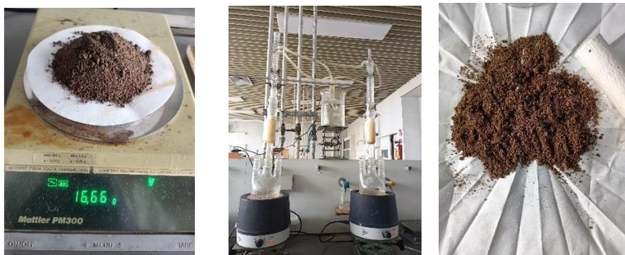
**Figure III.16.** Lavages au soxhlet
