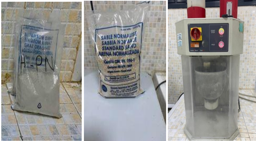
Figure II-3 : Préparation du mortier.
