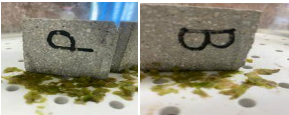
Figure III-13 : Dispositif de bioaltération par remontée capillaire de deux mortiers : B : brut, et P : avec 1.5% de polymère.
