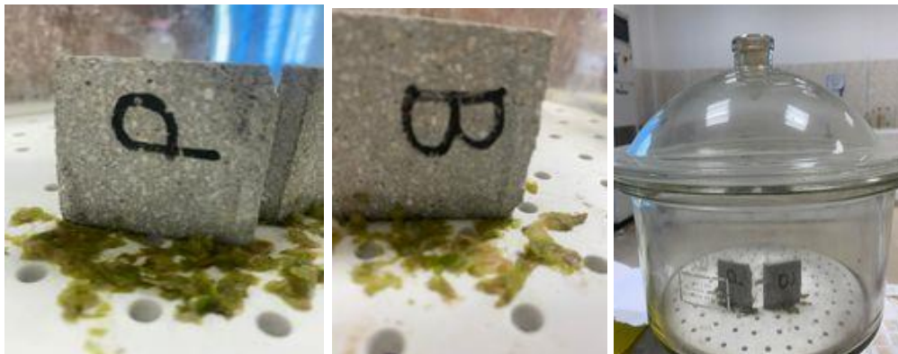
Figure II-13 : Dispositif de bioaltération par remontée capillaire en place dans un déclicteur de deux mortiers : B : brut, et P : avec 1.5% de polymère.
