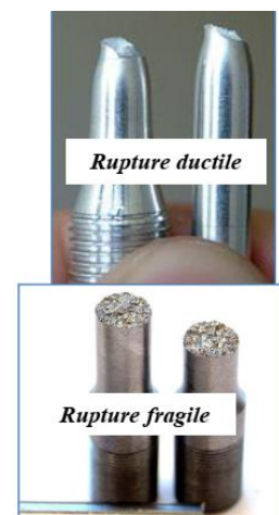
Figure II.3. Schéma d'une éprouvette de traction cylindrique et de son évolution en cours d'essai.
