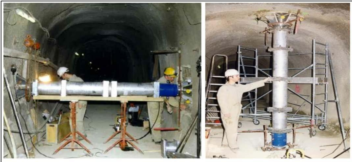
Figure 8-10: Mesure des contraintes par sur carottage
