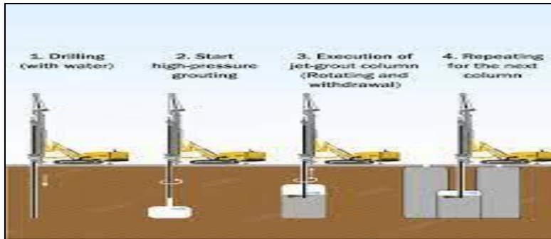
Figure 1-15: La consolidation par Jet Grouting
