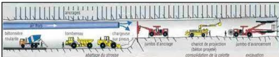
Figure 1-4: Phase de l'excavation à l'explosif
