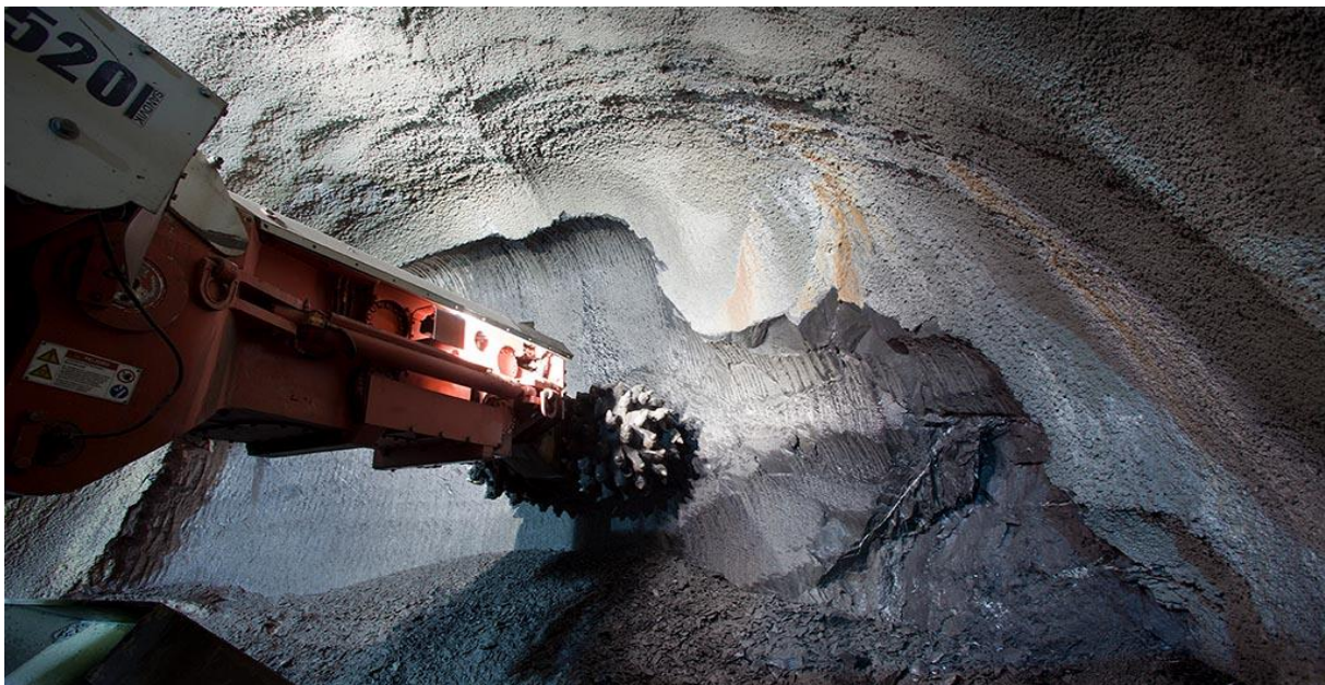
Figure I. 6: Machine à attaque ponctuelle
