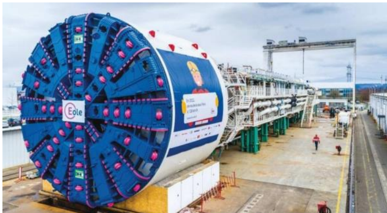
Figure I. 7: Machine à attaque globale(TBM)
