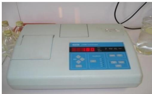
Figure V-9 : Turbidimètre
