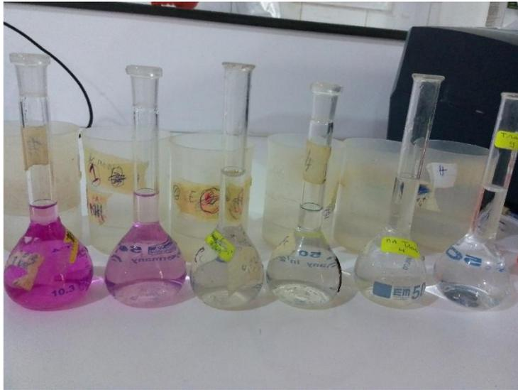
**Figure VI-16 :** Variation de la couleur de l'essai 1 lors de l'élimination des nitrites (après ajout de la solution de coloration des nitrites).
