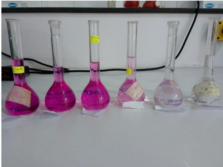
**Figure VI-19 :** Variation de la couleur de l'essai 2 lors de l'élimination des nitrites par oxydation à l'hypochlorite de sodium (après ajout de la solution de coloration des nitrites).
