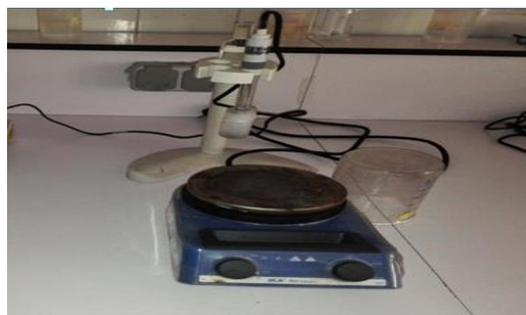
Figure V-11: Agitateur électromagnétique
