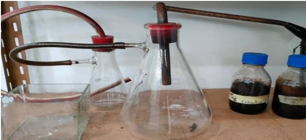
Figure 2: Dispositif de production de l'extrait aqueux enfumé (Original).
