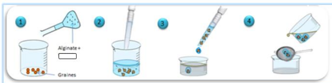
Figure 4 : Protocole d'enrobage des graines par l'alginate
