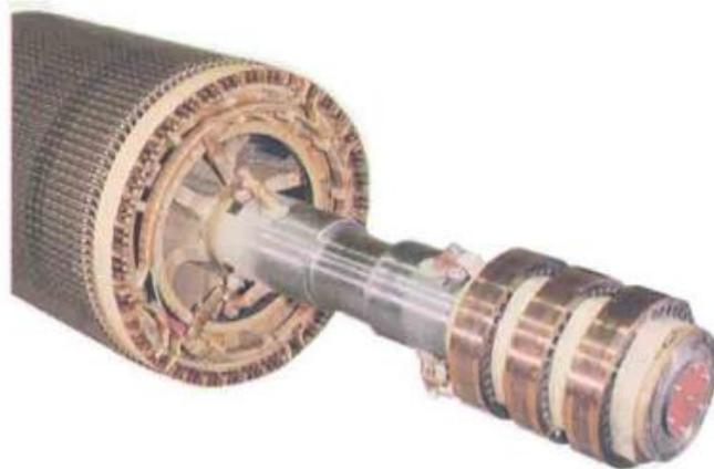
Figure III. 12 Rotor bobiné de moteur asynchrone
