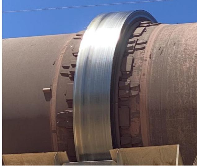
**Figure II. 3** Bandage du four rotatif
