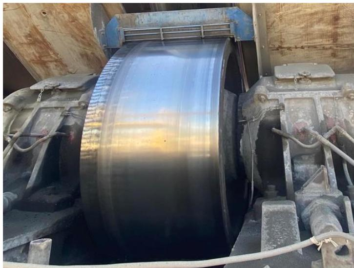
**Figure II. 7** Galet d'un four rotatif
