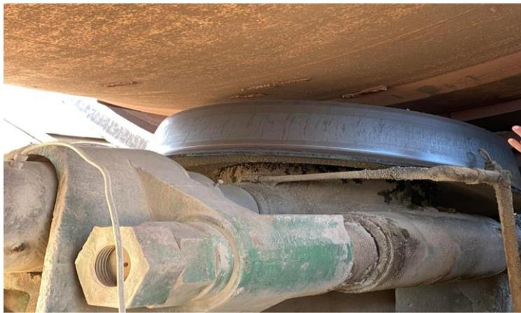
**Figure II. 8** Butée d'un four rotatif
