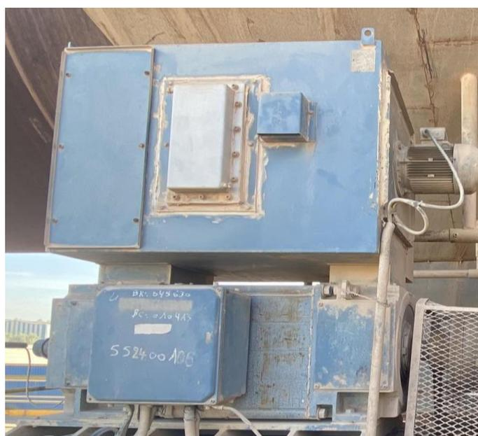
Figure IV. 3 Moteur à courant continu du four
