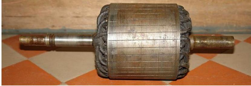
**Figure III. 10** Rotor d'un moteur asynchrone alternatif
