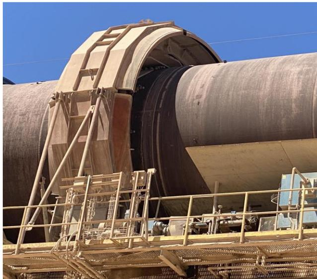
**Figure II. 2** Couronne du four rotatif
