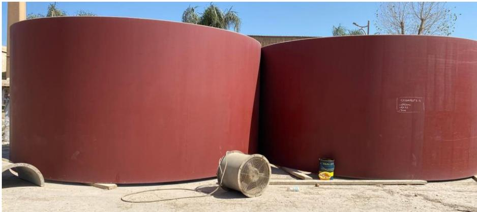
**Figure II. 5** Virole d'un four rotatif
