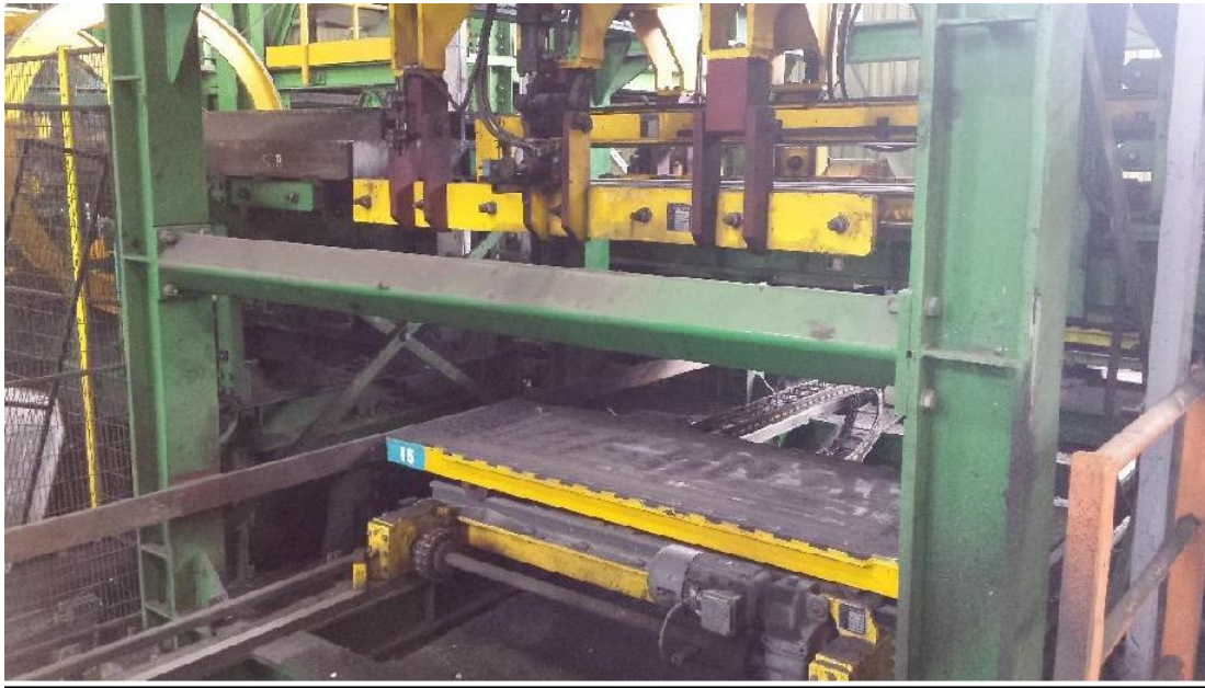
Figure 3.6: Machine à séparer les châssis
