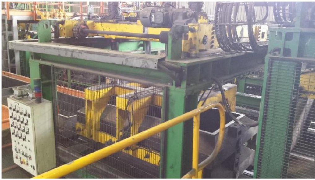
Figure 3.4: Machine à fermer les moules
