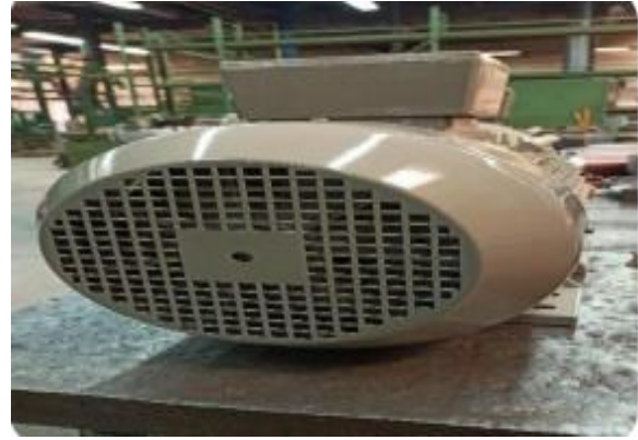
le coté ventilation
