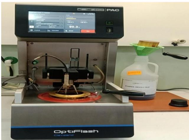
Figure V.4 : Appareil de mesure le point d'éclair
