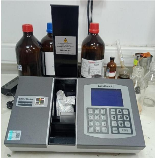
Figure.6 : Appareil de mesure la couleur ASTM
