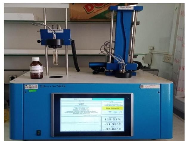
Figure V.5 : Appareil mesure le point découlement
