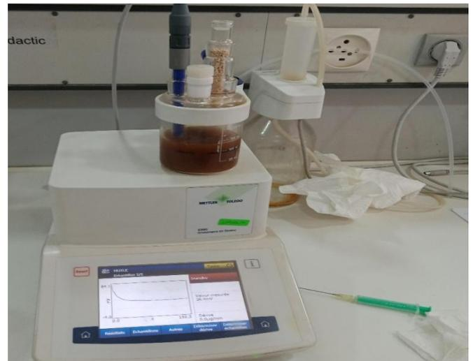
Figure V.9 : Appareil de mesure la teneur en eau
