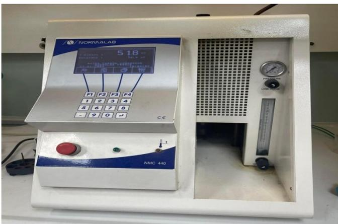
Figure V.10 : Appareil de mesure la teneur en résidu
