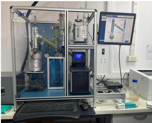
Figure V.8 : Appareil de mesure le point initiale d'ébullition
