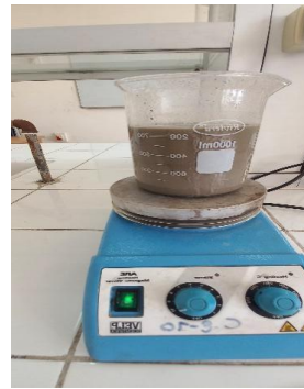
Solution H_2O_2 (5ml de H_2O_2 dans 1000ml d'eau distillée).
