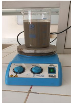
Chauffé sous agitation mécanique
