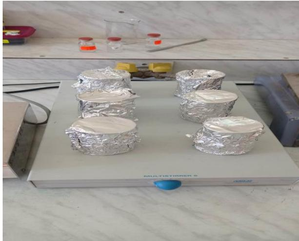
Figure III.9: Effet de la masse d'adsorbant.
