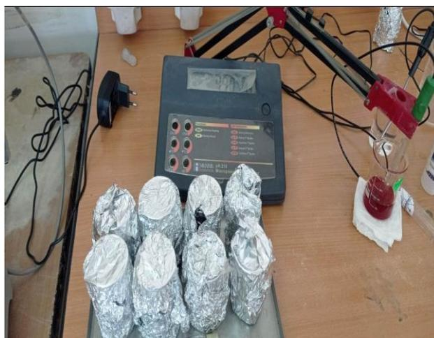
**Figure III.10** : Test de l'effet de temps de contact de colorant avec l'adsorbant.
