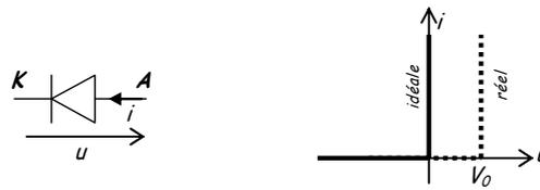
**Fig.1.8** Caractéristique réel d'un interrupteur
