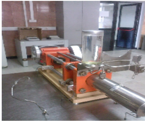
Photo-1 : La pompe à haute pression
