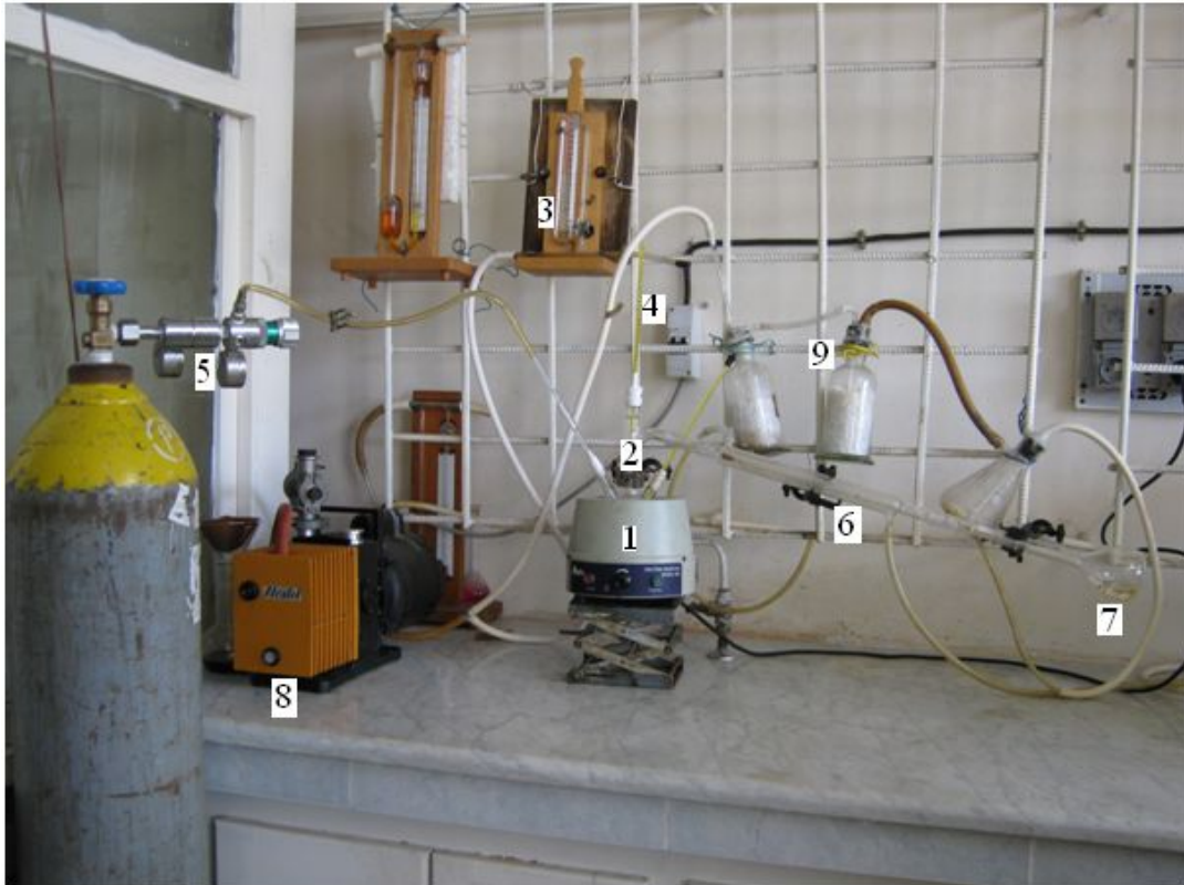
Figure. V.2 : schéma de l'installation de distillation sous vide
