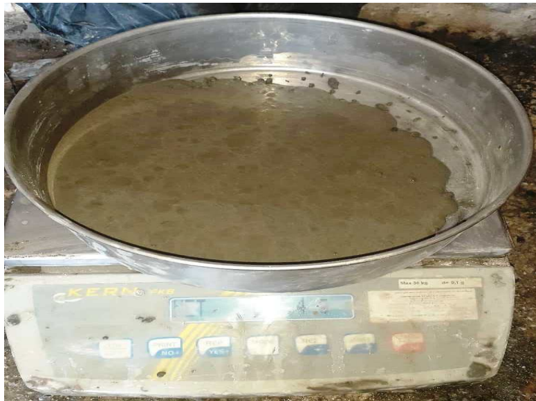
Figure.4: Essai de Stabilité au tamis.
