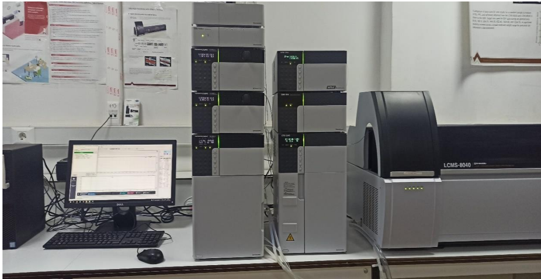
Figure 3. Appareil de chromatographie liquide couplée à la spectrométrie de masse (LCMS/MS) (Original).
