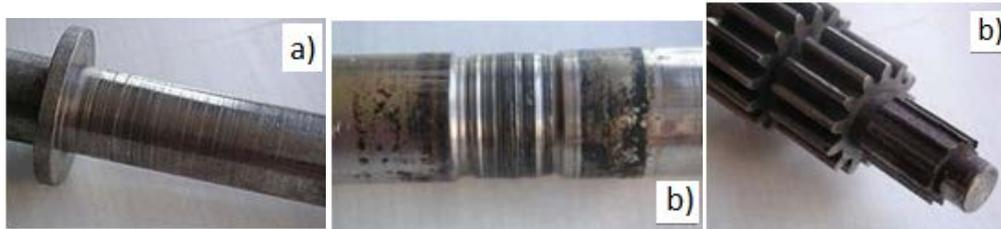
*Figure II.13 : Photos représentant des pièces usées par abrasion.*
