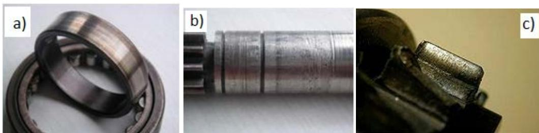
**Figure II.7 :** Photos représentant des pièces mécaniques ayant subies l'usure adhésive.
