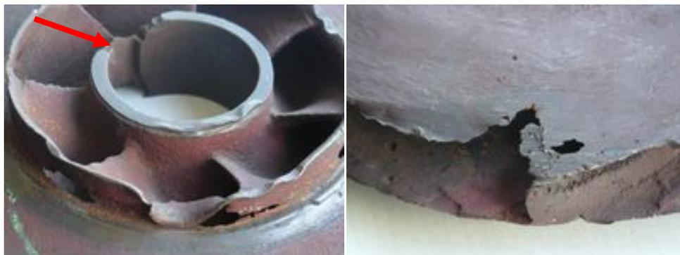
*Figure II.31 : Impulseur de pompe centrifuge avec une vue de la périphérie*
