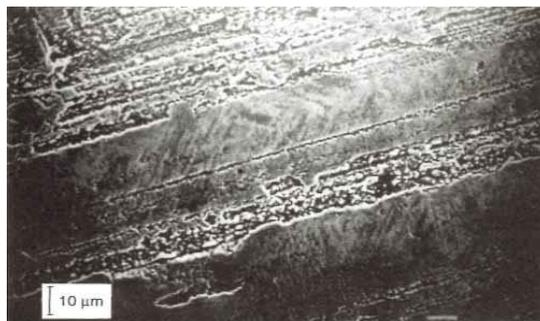
**Figure II.25 : Déformations plastiques superficielles**
