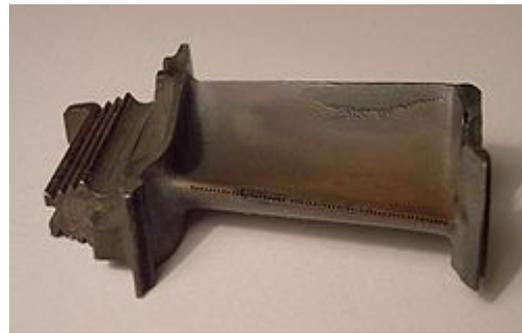
*Figure II.35 : Aube de turbine à gaz usée par érosion*
