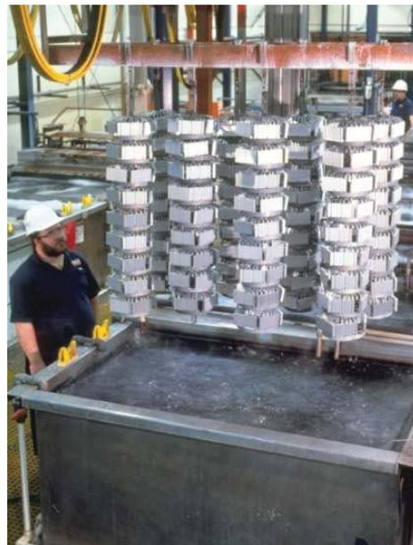
*Figure III.2 : Dépôt de revêtement par électrolyse.*
