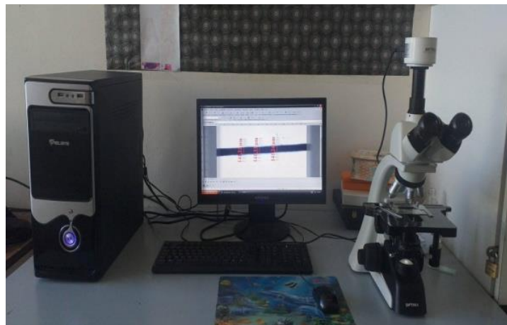
Figure III.21 Observation au microscope pour la mesure du diamètre.
