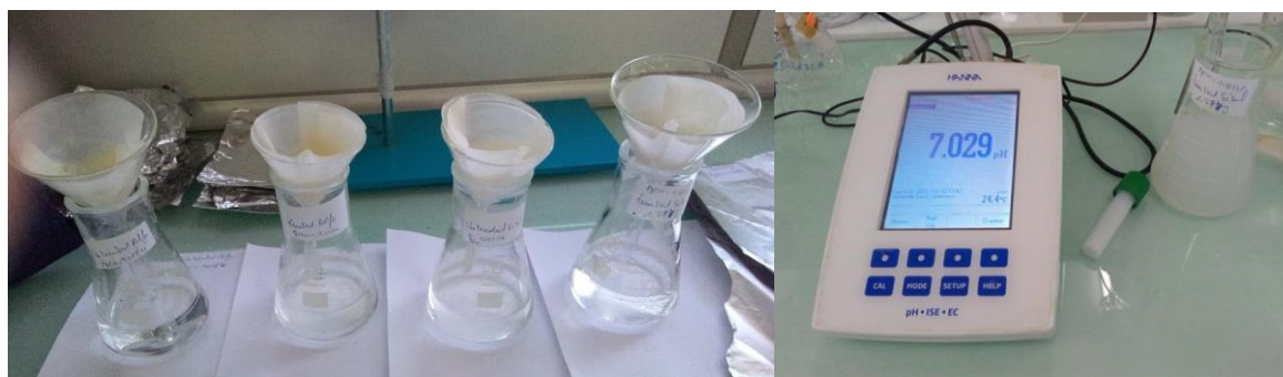
Figure 6 Dosage de l' \alpha -cellulose a) Ajout du NaOH b) Filtrer avec du papier filtre c) Rincer à l'eau distillée d) Neutraliser la solution PH=7
