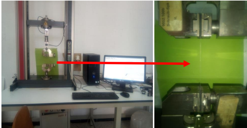
Figure III.22 Teste de traction des fibres de Sisal et d'Alfa traitées et non traitées.
