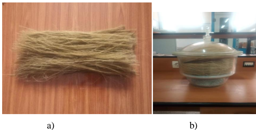
Figure III.6 Fibre d'Alfa a) avant et après traitement b) conservation dans un dessiccateur.
