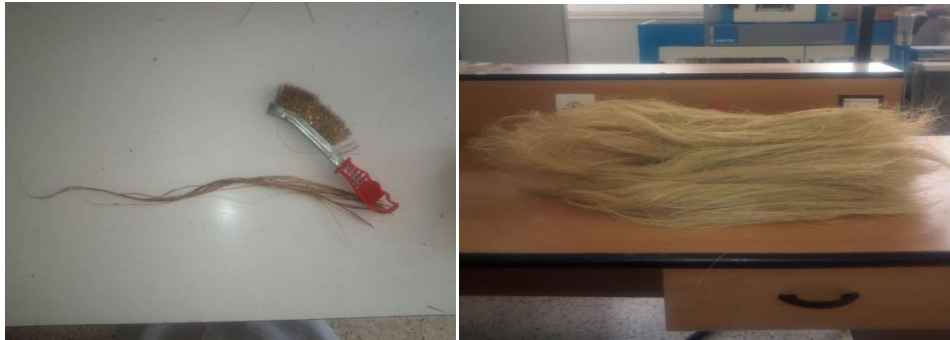
Figure III.3 Extraction des fibres étape 2 broissage mécanique.
