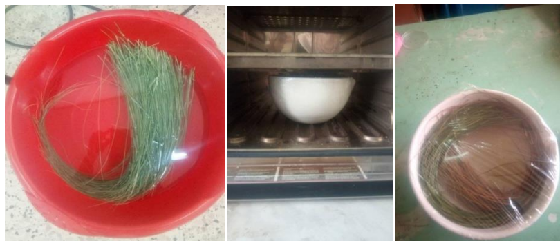
Figure III.2 Méthode d'extraction des fibres étape 1 trempage .
