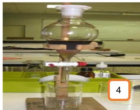
Extraction liquide/ liquide (décantation dans une ampoule à décompter)
