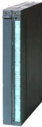
Figure 91 Module FM de commande de position
