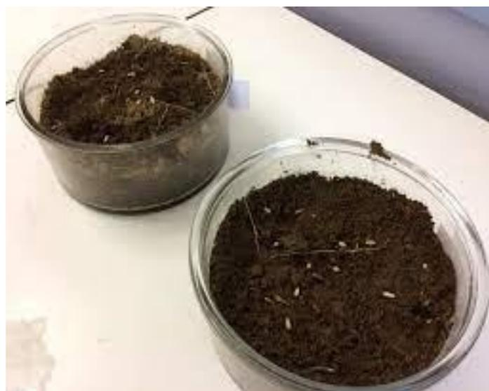
***Figure II.11 : la dégradation au sol d'un plastique et bioplastique***
