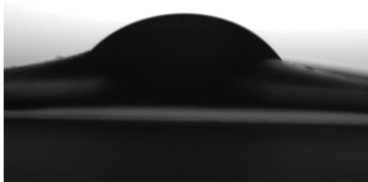
*Figure III.3 : Image de la pénétration la goutte d'eau dans le film d'amidon pure.*
