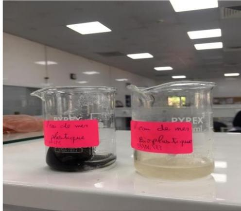
*Figure III.7 : Dégradation de film bioplastique et de plastique dans l'eau salée.*
