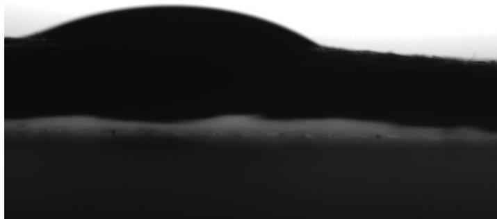
*Figure III.4: Image de la pénétration la goutte d'eau dans le film (amidon/cellulose)*
