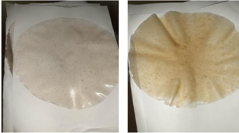
*Figure II.4 : les films bioplastiques obtenus (simple, renforcé par la cellulose).*
