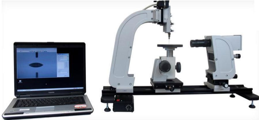
*Figure II.7 : image du goniomètre pour mesure angle de contact au CRTSE.*
