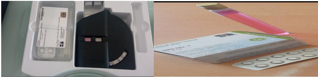
Figure 52 : Photo de comparateur de chlore de marque CHEKIT LOVIBOND147010.
