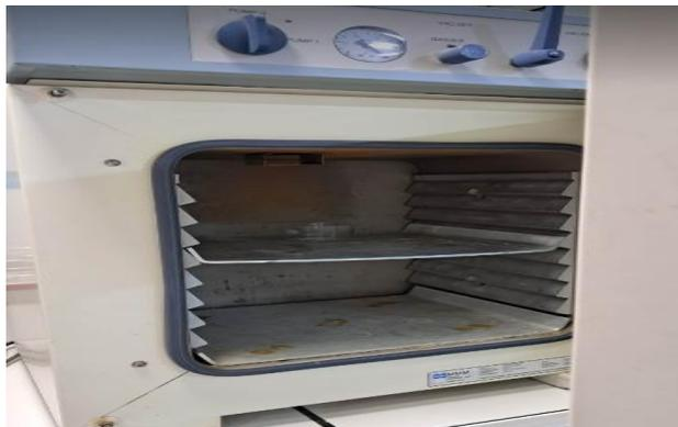
**Figure III.12 :** Test de résidu sec.
