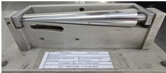
Figure II.9: Appareil de pliage conique
