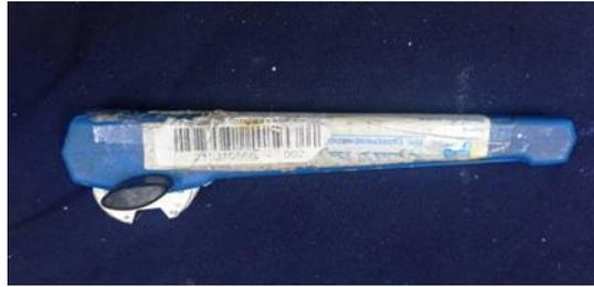
Figure II.7 : Jauge d'épaisseur magnétique.
