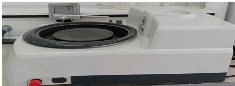
**Figure II.1 :** Appareil de polissage
