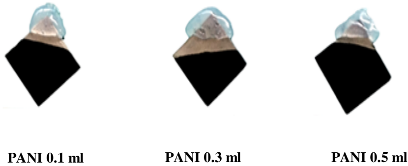
Figure II.8 : Les plaques d’acier inoxydable avec le dépôt de la polyaniline
