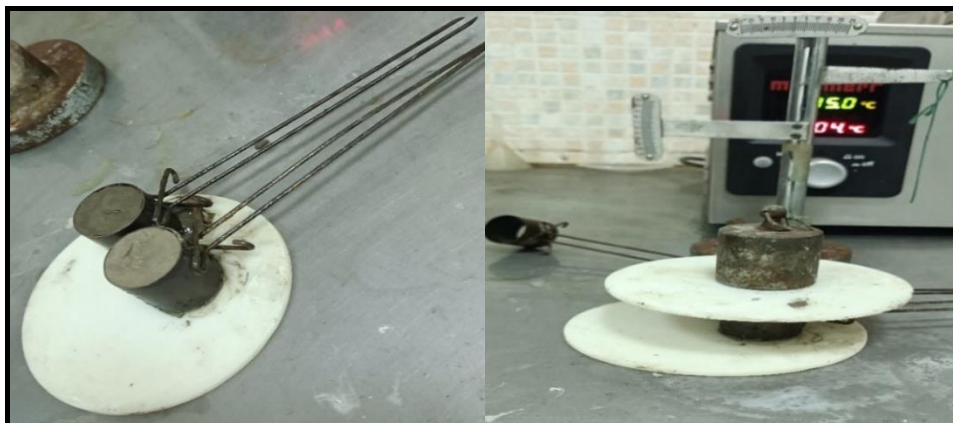
Figure II.17 : Représentation du moule de Chatelier
