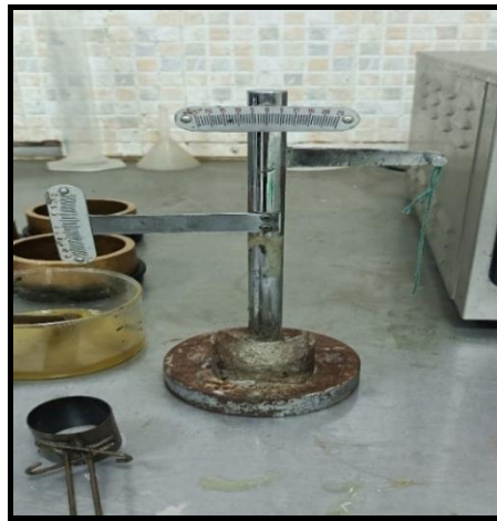
Figure II.18 : Appareil Vicat pour la mesure d'expansion
