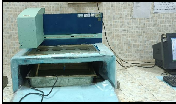
Figure II.16 : Détermination de début et fin de prise par l'appareil Vicat
