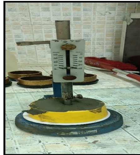
Figure II.13 : Mesure de la consistance du liant (ciment+MK) par l'appareil Vicat
