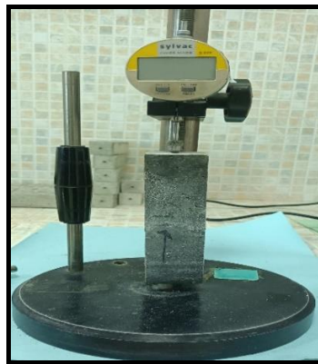
Figure II.30 : Appareil de mesure (retrait et gonflement)
