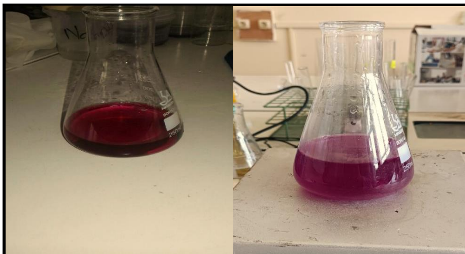
Figure II.34 : Virage de couleur de la solution titrée par EDTA
