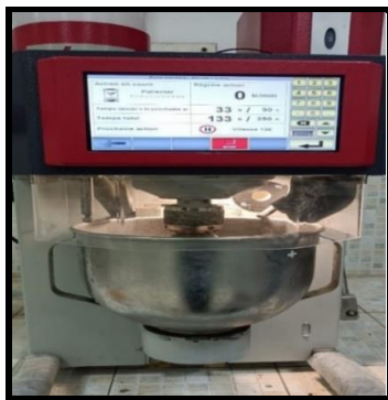
Figure II.5 : Malaxage des constituants
