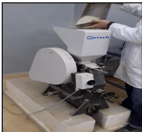
Figure II.3 : Broyage du kaolin
