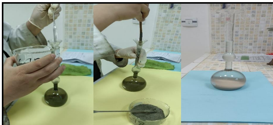
Figure II.20 : Remplissage de liant dans le volumétre
