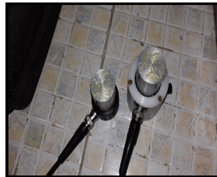
Figure II.29 : Récepteur et émetteur intérieur des ondes entre l'éprouvette et le transducteur
