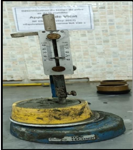
Figure II.12 : Mesure de la consistance normale du ciment (témoin)
