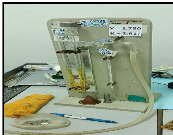
Figure II.22 : Appareil de Blaine pour la mesure de la surface spécifique
