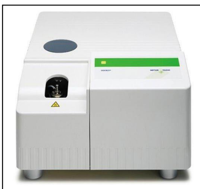
Figure II-8 : Appareil d'analyse enthalpique différentielle de type Mettler Toledo 823 DSC (LMP-USTHB)
