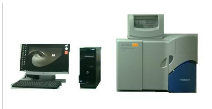
Figure II-6 : Granulomètre à laser de type LA 950. (CRD-Sonatrach)
