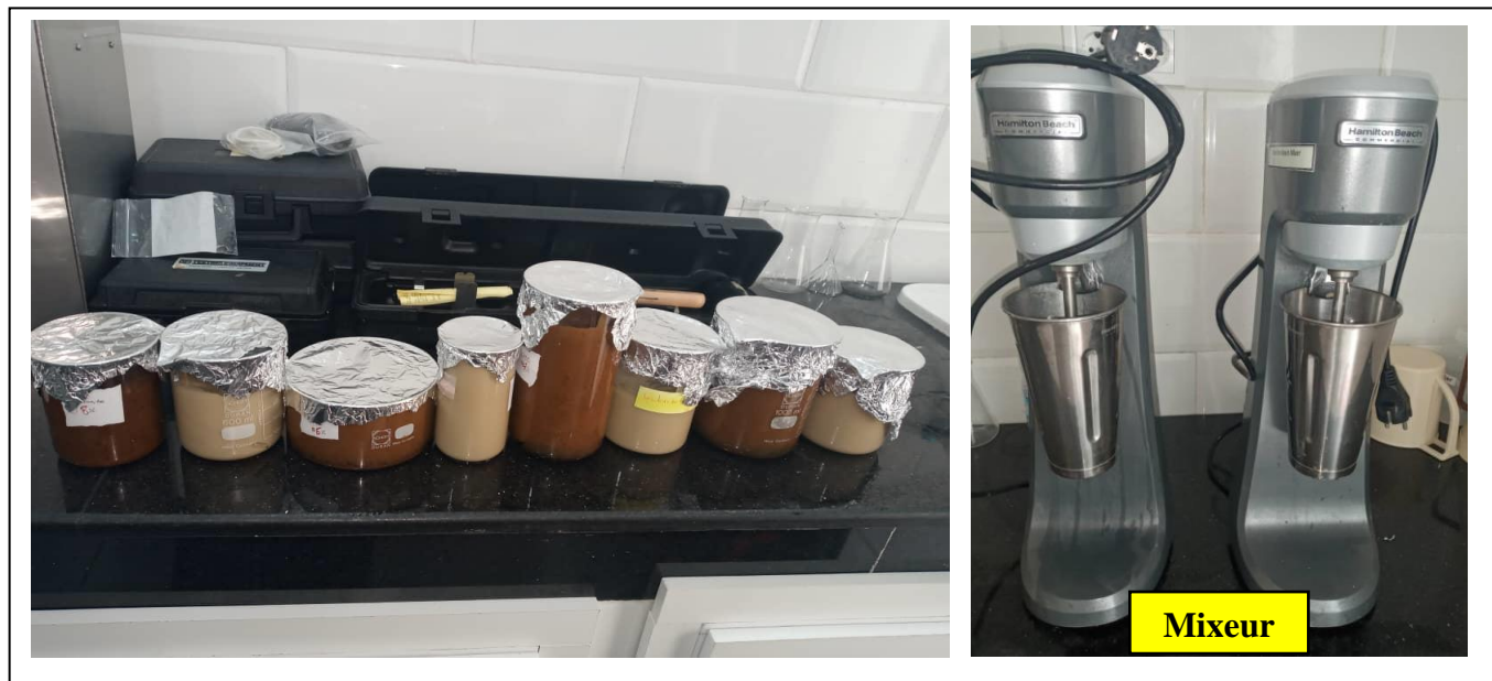
Figure II-24 : Formulation de la boue de forage à base de l'eau
