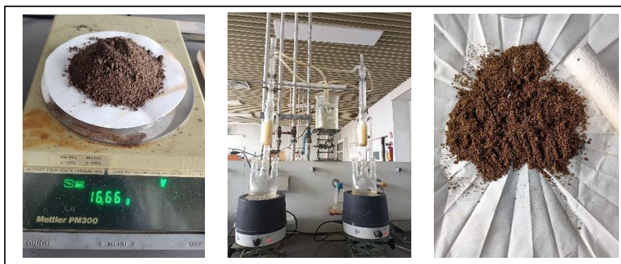
Figure II-16 : Lavages au Soxhlet
