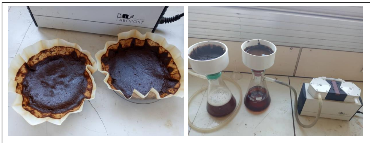
Figure II-20 : Filtration de la lignine
