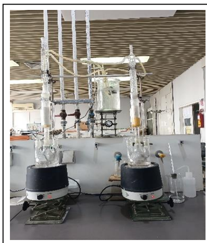
Figure II-15 : Montage de Soxhlet
