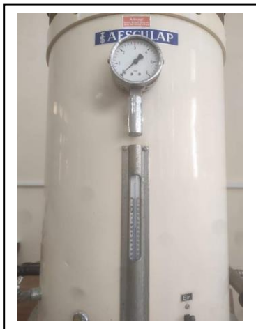
Figure II-17 : Extraction de la liqueur noire à l'aide d'un autoclave
