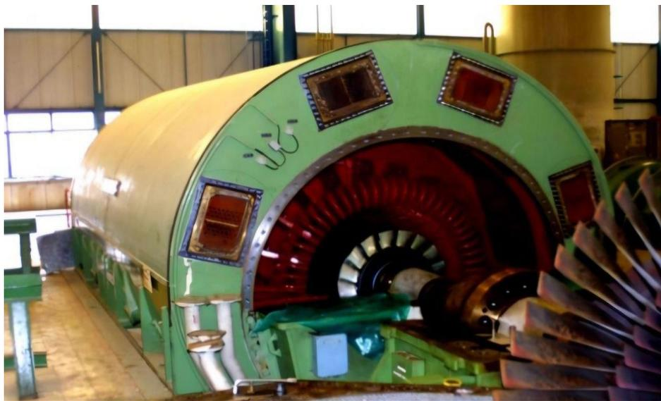
**Figure I.5** : L'alternateur de la centrale [2]
