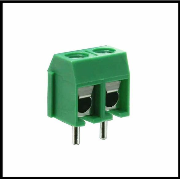
Figure IV.10 : Bornier à 2 vis
