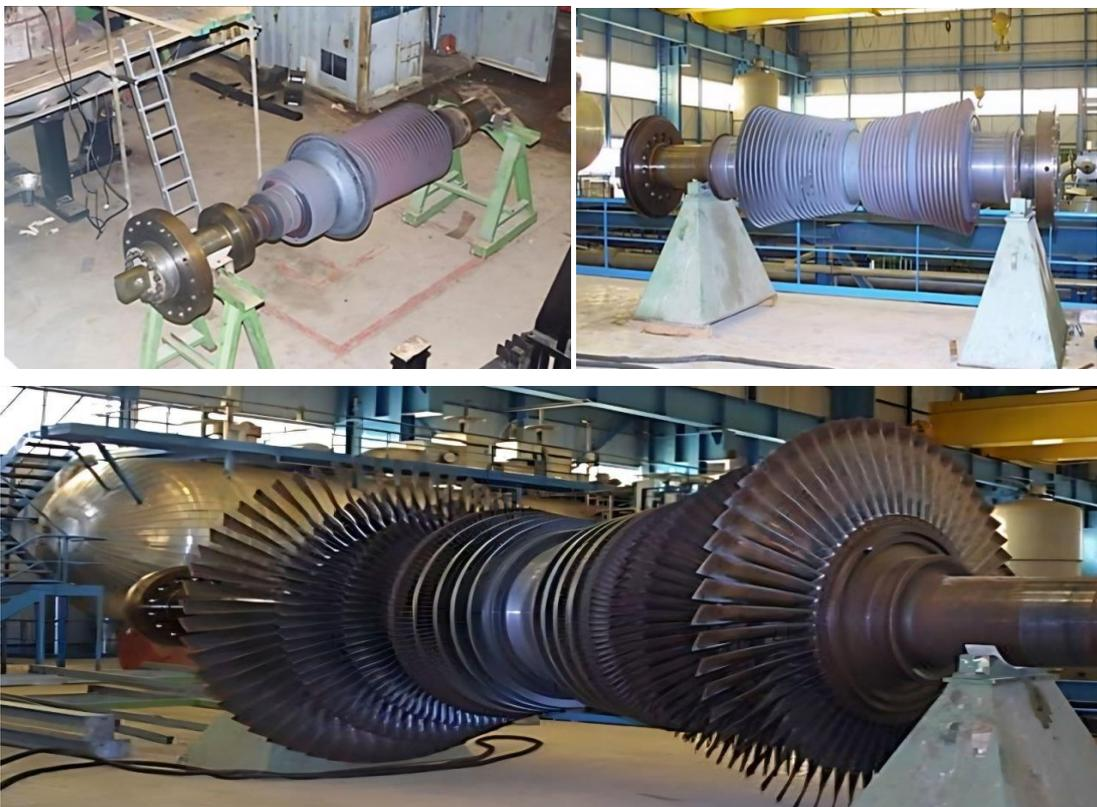
Figure I.4 : Images des trois corps de la turbine à vapeur [2]
