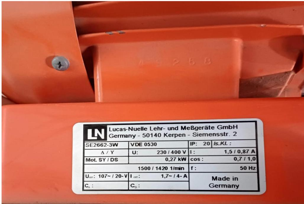
Figure IV.8 : Plaque signalétique du moteur asynchrone triphasé
