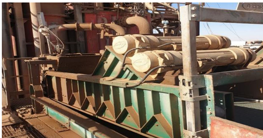
Figure 1.5 : Tamis vibrant de RIG ENF#61.
