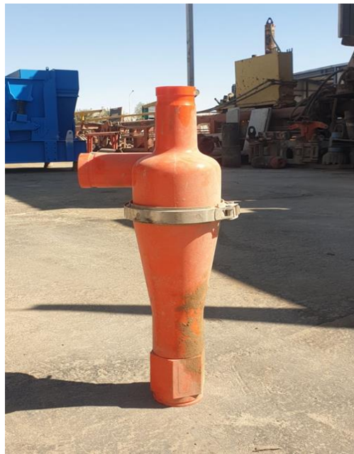
Figure 2.1 : Photo réel d'un hydrocyclone de marque derrick.
