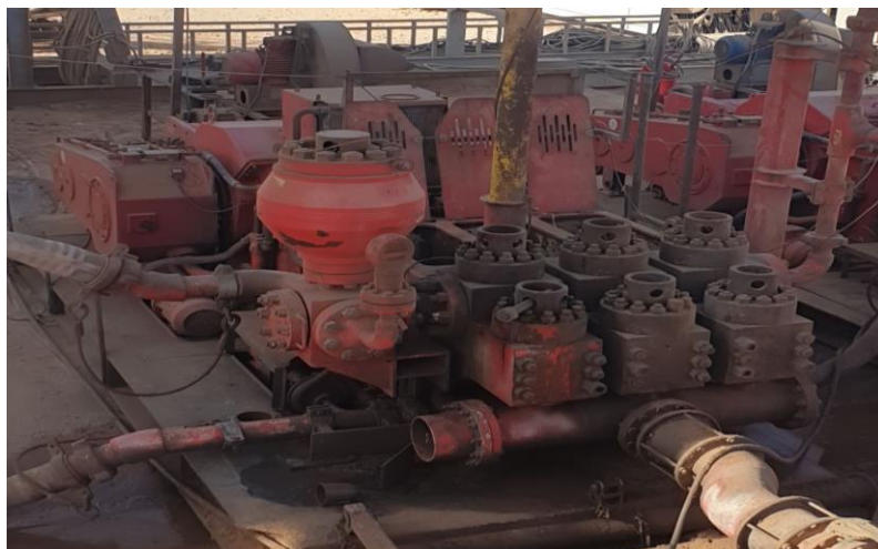
Figure 1.3 : La pompe à boue de RIG ENF#61.
