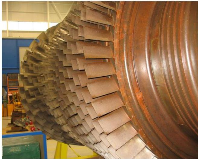
Figure 2. 3 : Etage du compresseur.
