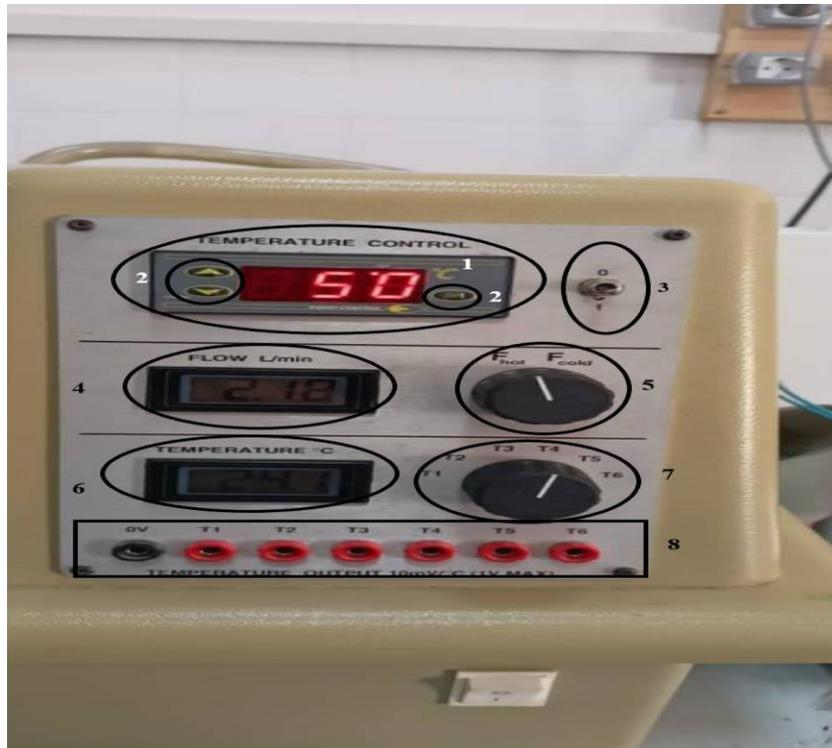
Figure III. 3 : Panel de contrôle.
